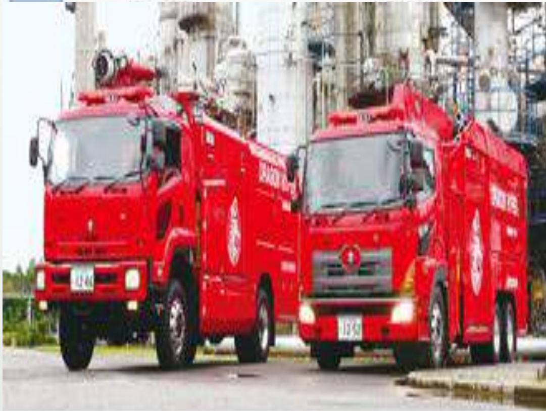
ドラゴンハイパー・コマンドユニットの中核車両である大型放水砲車（左）と大容量送水ポンプ車（右）
